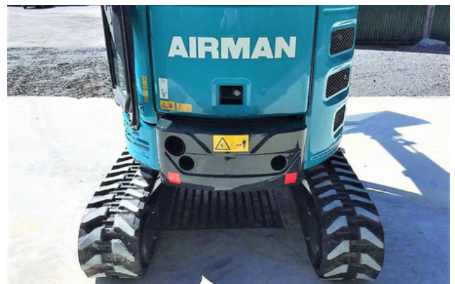
Tillräckligt med utrymme runt bränsletankens öppning för att det ska vara lätt att tanka.
