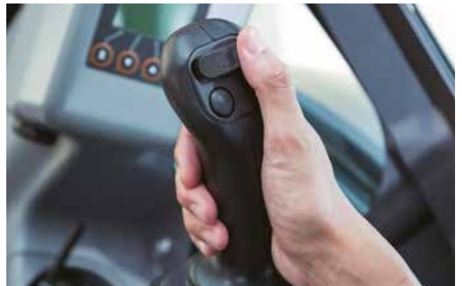
Det proportionella reglaget säkerställer följsam och precis kontroll av redskapet.
