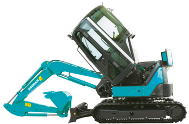
Det lutande golvet gör det enkelt att komma åt motorn och styrventilen för snabbservice.
